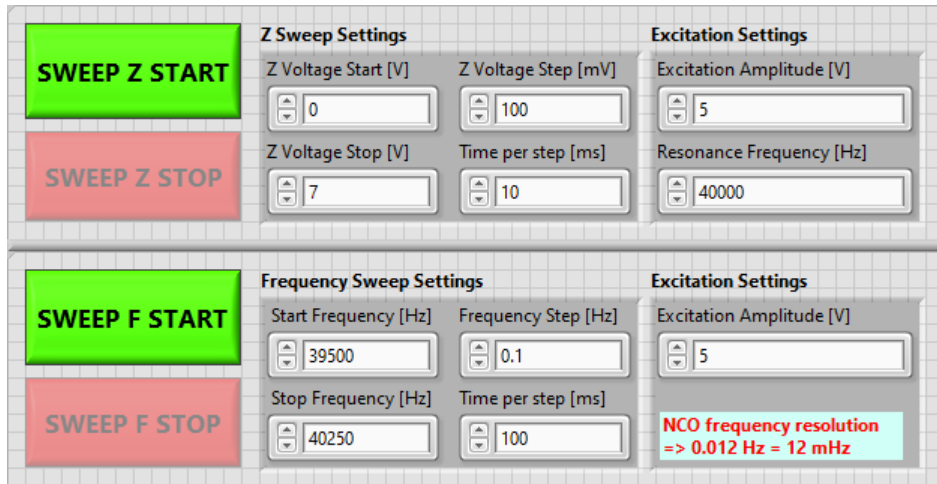
Figura 3.20: Schermata del software di controllo dell'AFM: sezione dedicata all'impostazione dei parametri degli sweep implementati
